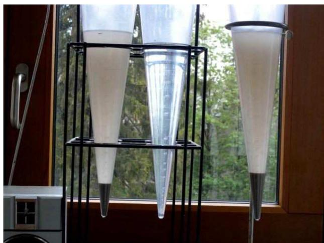
Abb. 3: Versuchsanordnung mit Imhoffrichter
